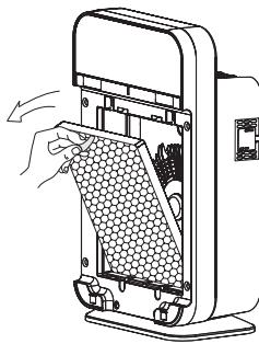
5. 拆掉M8高效过滤器的包装，并将其装回净化器原位置。
