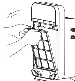
3. 双手按住微静电过滤器上端两个卡扣，将其取下。
