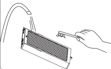
4.将洗净过滤器上的水甩干，放置在通风良好的地方，待其干透后再重新放入机器。参照13页。
