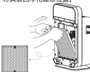
6. 依次将微静电过滤器、初效过滤器装回原位置，装好前面板。
