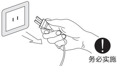
请不要用拖拉电源线的方式移动本产品。
