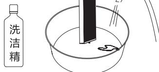
3.将浸泡后的微静电过滤器拿到自来水下冲洗，配合软毛刷直至清洗干净。
