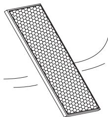
4.M8甲醛过滤器在使用6个月后建议更换，最长使用时间不超过9个月。
