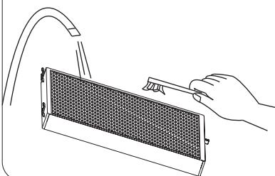
4.将洗净过滤器上的水甩干，放置在通风良好的地方，待其干透后再重新放入机器。参照16页。
