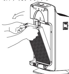
4. 拆掉M8甲醛过滤器的包装，并将其装到净化器中。
