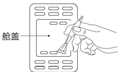
2. 取下舱盖,用棉棒擦拭传感器图示位置的内部透镜，棉棒可蘸少量清水，湿润即可，切勿使用酒精。传感器可每月进行一次清洁。
