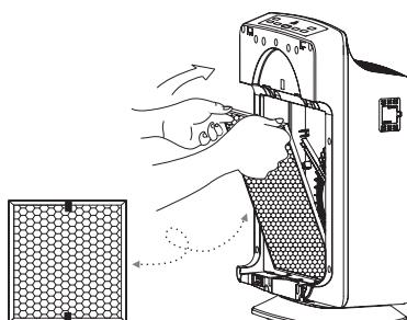
5. 依次将微静电过滤器、初效过滤器装回原位置，装好前面板。
