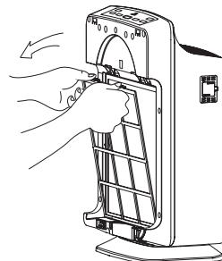
3. 双手按住微静电过滤器上端两个卡扣，将其取下。
