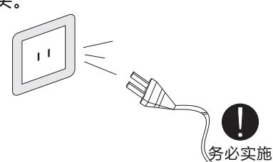
维护保养前请先拔掉电源插头。
